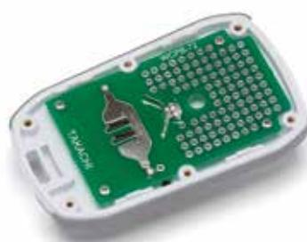
Montieren sie das PCB in die Oberschale
