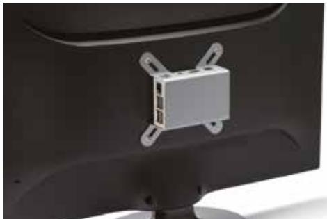
RPI-1F ist kompatibel mit VESA Halterung (75 x 75mm / 100 x 100mm) und kann auf der Rückseite von Monitoren befestigt werden.
